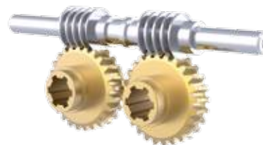
SSD Diseño Caja de engranes
