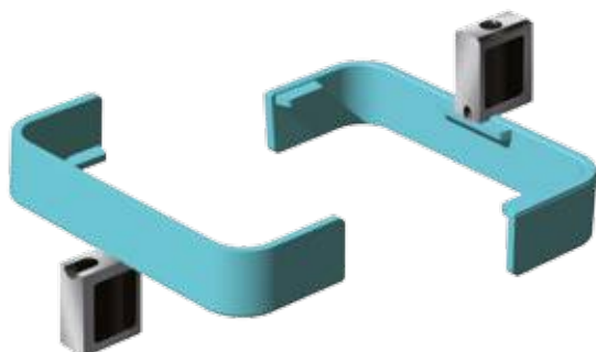
Punto de inyección partido en dos
