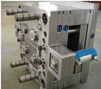
Motllo taps accionat per motor hidràulic
